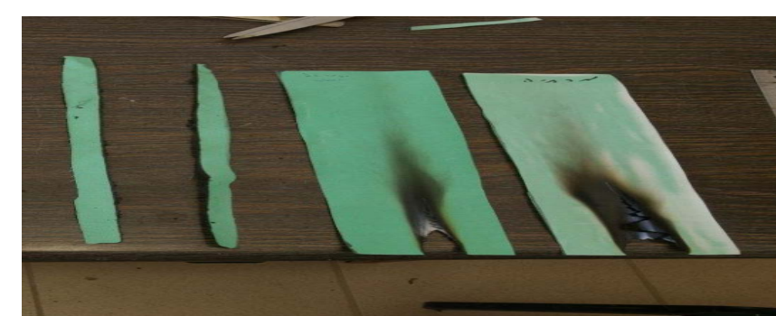
איור 2: השוואת הבדים מימין לשמאל: בד שעבר תהליך מריחה, הספגה, שלא עבר אשפורה כלל.
